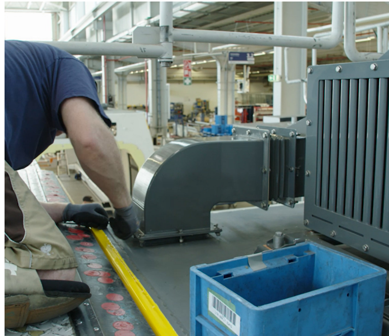
Sistema final personalizado de ventilación impreso en 3D en resina ULTEM™ 9085.
