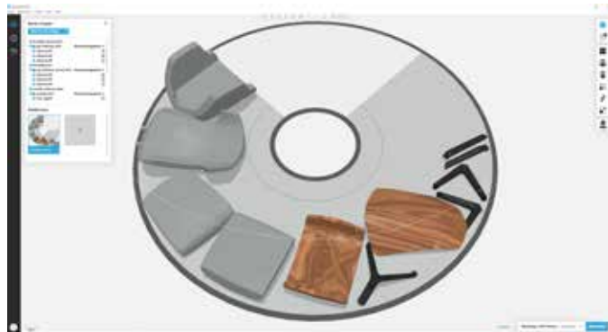
Modelo de silla diseñada por Thinkable Studio en el software GrabCAD Print, mostrado en la exclusiva plataforma de impresión giratoria de la J55
