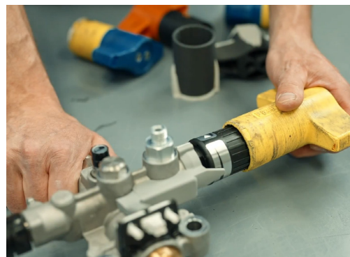
Il vecchio utensile in ABS è raffigurato (in giallo) nel punto di innesto della manopola di regolazione su un dispositivo di controllo della pressione.
