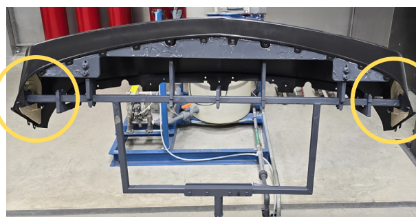
Dois exemplos de máscaras impressas em 3D (em destaque) posicionadas sobre uma peça montada no fixador de pintura.
