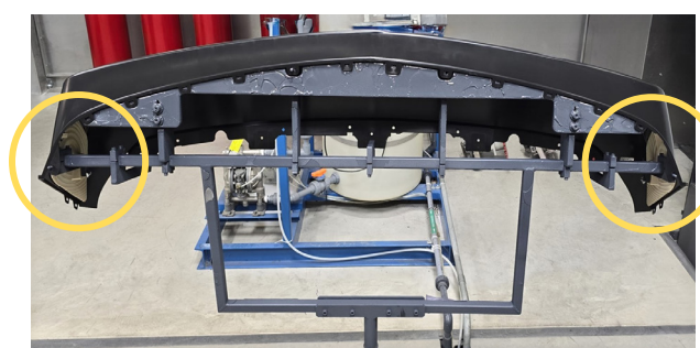
Due esempi di maschere stampate in 3D (in evidenza) installate su un dispositivo di fissaggio della linea di verniciatura.
