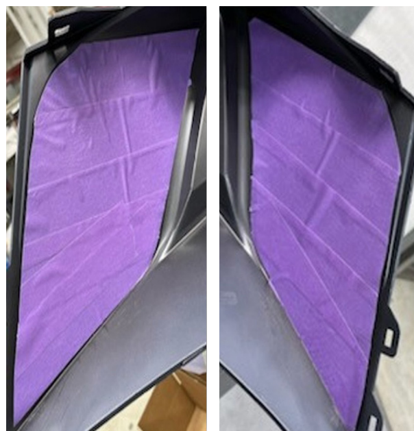
Il nastro applicato alle maschere di verniciatura stampate in 3D consente di verificare l'efficacia della mascheratura.
