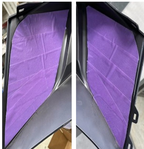
Le ruban adhésif appliqué sur les masques de peinture imprimés en 3D vérifie l'efficacité du masquage.
