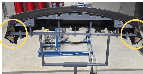
Deux exemples de masques imprimés en 3D (surlignés) installés sur une pièce dans le posage de peinture.
