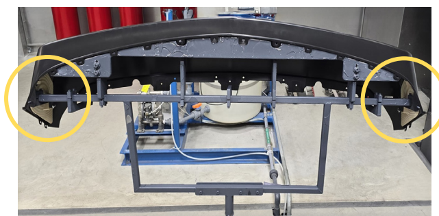
Dos ejemplos de máscaras impresas en 3D (resaltadas) instaladas en una pieza del accesorio de pintura.
