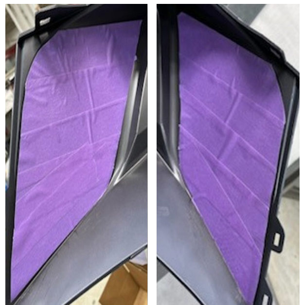
Das auf die 3D-gedruckten Farbmasken aufgebrachte Klebeband prüft die Wirksamkeit der Maskierung.
