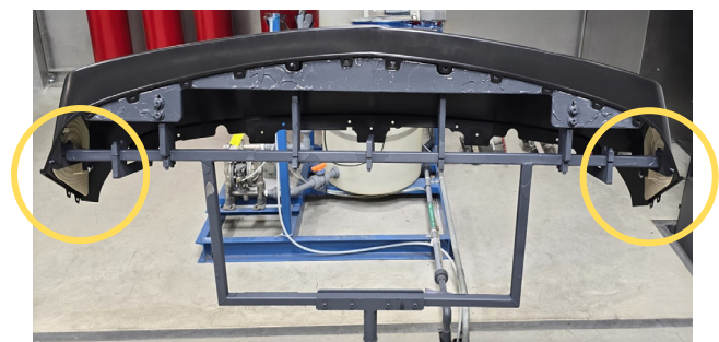
Zwei Beispiele von 3D-gedruckten Masken (hervorgehoben), die auf einem Teil in der Lackiervorrichtung installiert sind.
