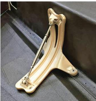
Indaero verwendet aus dem Kunstharz ULTEM™ 9085 3D-gedruckte Produktionswerkzeuge, um komplexe Formen herzustellen, die perfekt an die Krümmung von Flugzeug-Tragflächen angepasst sind, was mit herkömmlichen Aluminiumwerkzeugen nicht möglich ist.
