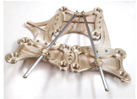
Indaero hat ein Werkzeug neu konstruiert und in 3D gedruckt, das neun Kilo leichter ist als das traditionell hergestellte Werkzeug.
