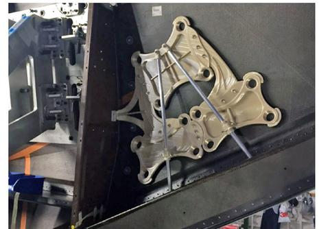
Das neue 3D-gedruckte Fertigungswerkzeug aus widerstandsfähigen ULTEM™ 9085 passt sich eigenständig an gekrümmte Tragflächen an, was die Anwender entlastet und die Lieferzeiten an den Kunden verkürzt.
