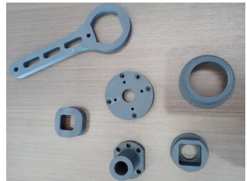
Bauteile eines Lösewerkzeugs für Bolzen aus dem Material Nylon-CF10.
