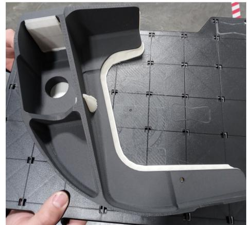
Prüfgerät für Flugzeuge aus der Kohlefaser Nylon-CF10.
