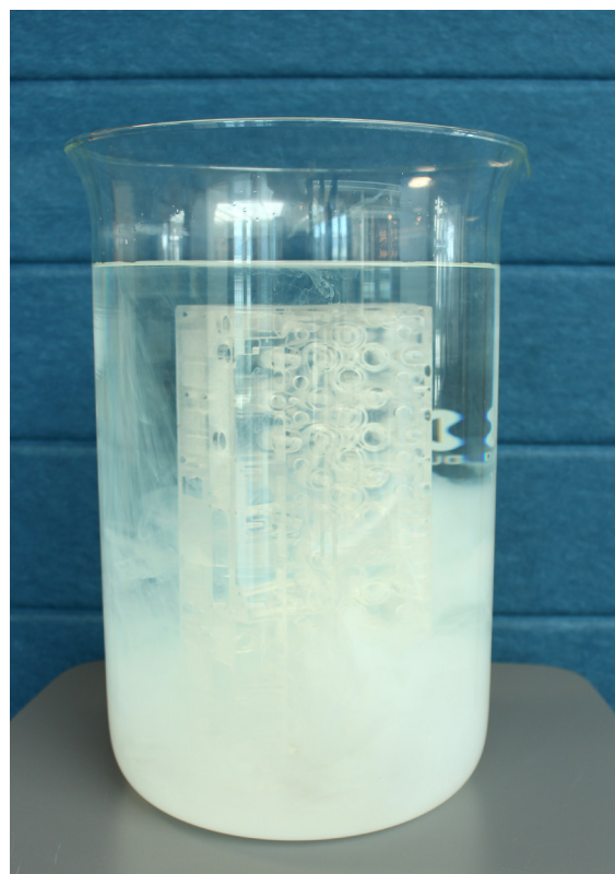
Eliminación de WSS™150 (soporte soluble en agua) con agua del grifo.
