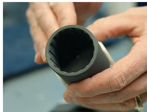
Das 3D-gedruckte Anschlussstück des Handgeräts mit Keilverzahnung und glatt gedruckter Oberflächenausführung.
