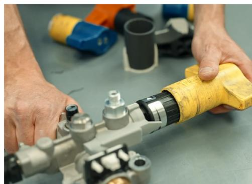
Das alte ABS-Handgerät (gelb) mit dem am Druckkontrollgerät eingerasteten Einstellknopf.
