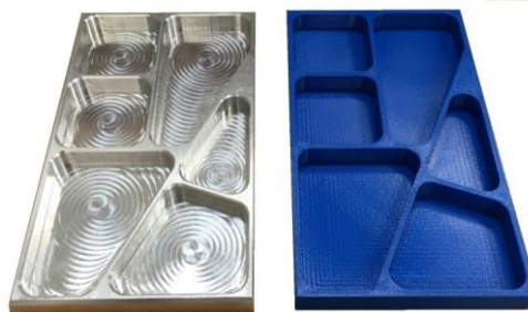
Figura 1. CNC (alluminio) a sinistra, stampa in 3D (plastica), a destra.
