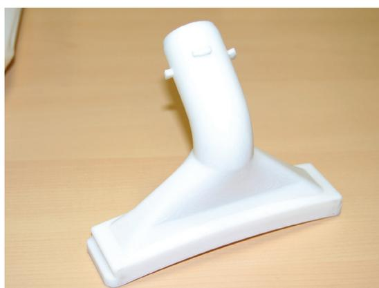
Buse d'aspiration imprimée en 3D pour éliminer les particules contaminantes, produite à l'aide de l'imprimante 3D Fortus 450mc.
