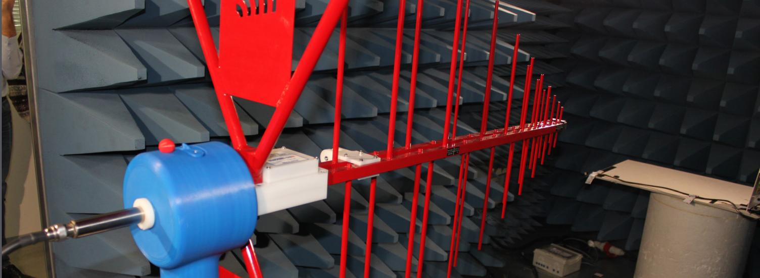
Support rotatif pour une antenne de test Bluetooth imprimée en 3D avec la Fortus 380mc.
