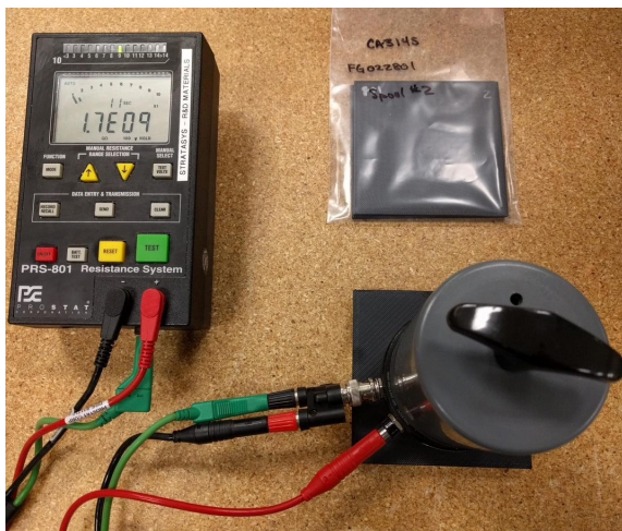
Illustration 1. Ohmmètre PRS et sonde à anneaux concentriques.
