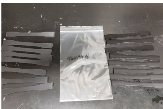
Figura 6. I campioni dopo l'esposizione al toluene.
