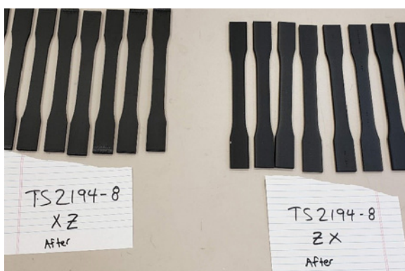
Figura 8. I campioni dopo l'esposizione all'acido nitrico al 30%.
