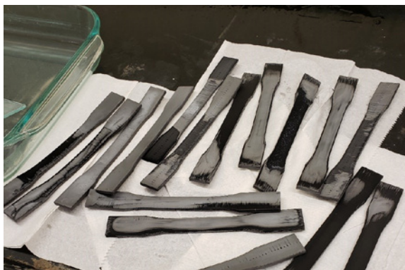
Figura 4. I campioni dopo l'esposizione al DCM.
