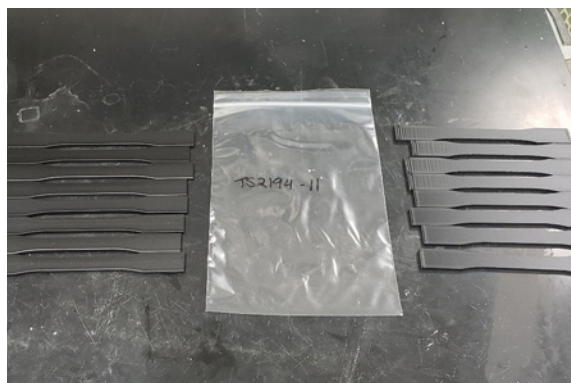
Figura 11. I campioni dopo l'esposizione all'idrossido di ammoniaca concentrato.
