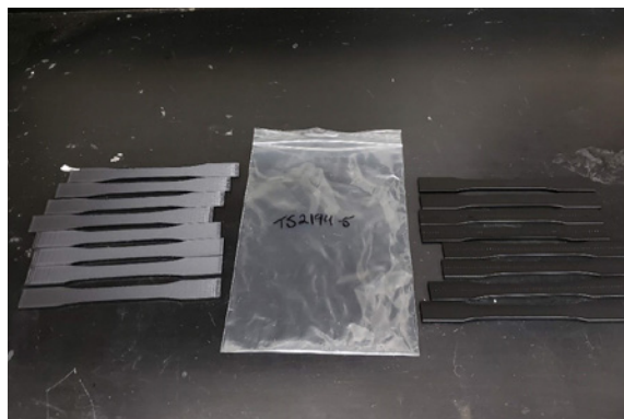
Figura 5. I campioni dopo l'esposizione all'acetato di etile.
