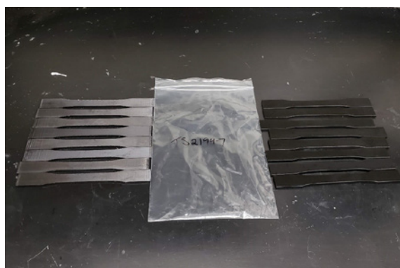
Figura 7. I campioni dopo l'esposizione al Jet A.
