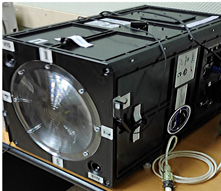
La struttura di Mini-EUSO Flight Model è stata realizzata in resina ULTEM™ 9085 con la stampante 3D Fortus 450mc.
