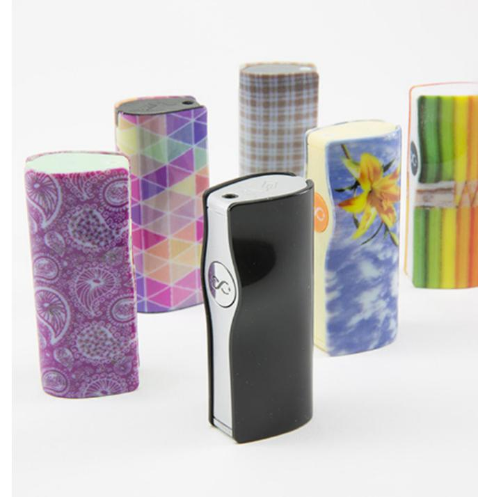
La technologie Polyjet de Stratasys a permis aux concepteurs de Synergy de réaliser des prototypes avec différentes images pour parfaire la conception de cette pochette de chargeur de téléphone.
