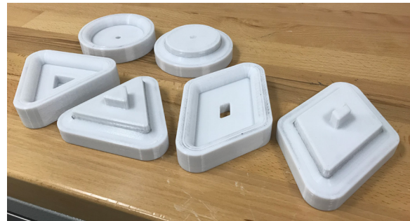
Illustration 2-4 : Outil d'évasement personnalisé imprimé en polycarbonate.
