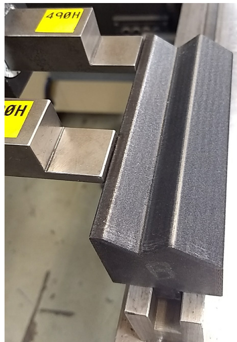
Illustration 4-4 : Outil imprimé sur la presse plieuse.
