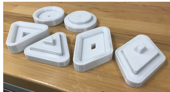
Abbildung 2-4: Benutzerspezifisches Stanzwerkzeug aus Polycarbonat
