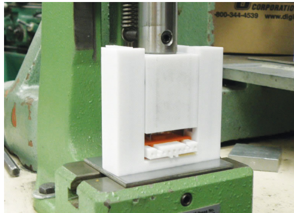
Un opérateur de Xerox a modifié 350 connecteurs en une heure environ sur cette presse à genouillère.
