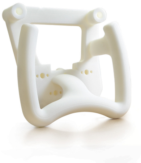
Les gabarits et fixations de BMW utilisent un système de production 3D Fortus® pour fabriquer des outils de montage. Celui-ci est utilisé pour placer le logo du nom à l'arrière du véhicule.
