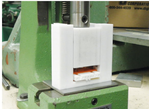
Un operador de Xerox modificó 350 conectores en alrededor de una hora en esta prensa de palanca.
