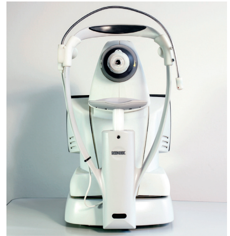
Der Prototyp des Gonioscope® wurde mit Teilen aus dem 3D-Drucker zusammengesetzt.
