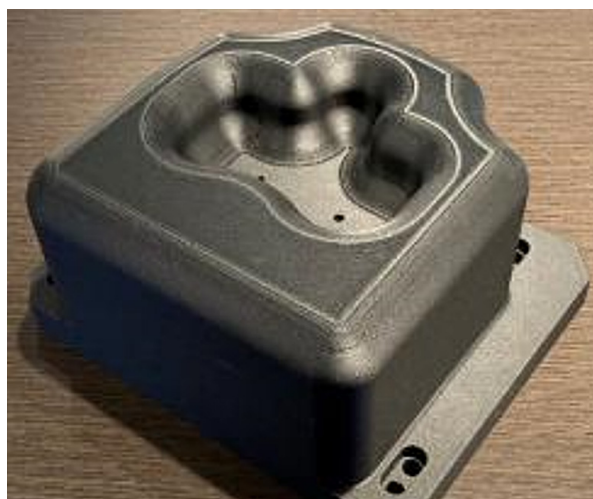
Punção FDM Nylon 12CF.
