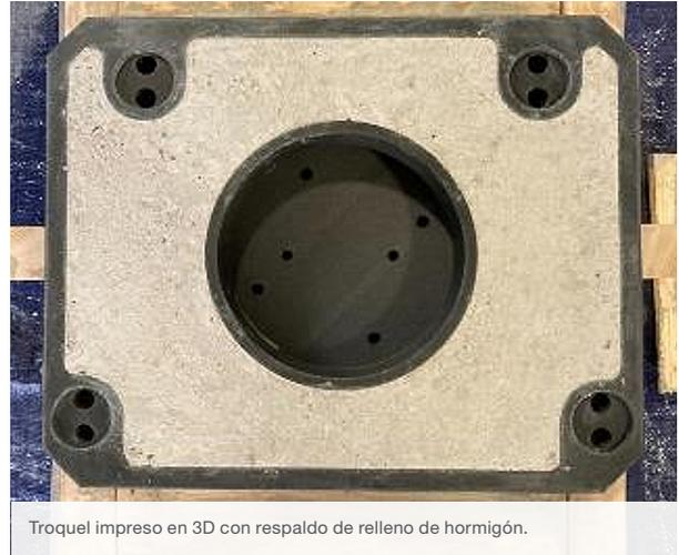
Troquel impreso en 3D con respaldo de relleno de hormigón.
