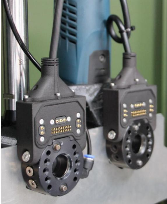
Entscheidend ist, dass man den Steckverbinder für unterschiedliches Werkzeug nutzen kann und dass er Hochstrom standhält. Jeder Hochstromstift kann bis zu zehn Ampere aufnehmen. Jeder Datenstift für Niedrigstrom kann zuverlässig ein Ampere weitergeben.
