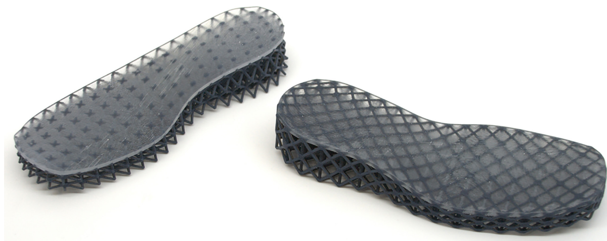
I ricercatori del DManD hanno creato strutture a reticolo morbido multi-materiale per questo prototipo di calzatura, utilizzando strumenti di progettazione, analisi e slicer personalizzati per controllare spazialmente la rigidità e la non linearità.
