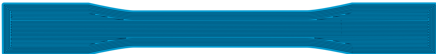
Abbildung 6 – Werkzeugwege des D638-Zugcoupons mit unidirektionalen Werkzeugwegen im verengten Bereich.
