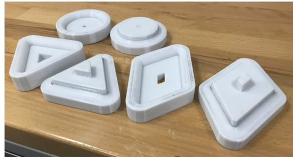
Figura 2-4: Attrezzaggi di svasatura personalizzati stampati in policarbonato.
