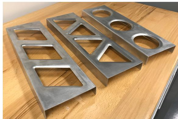
Figura 2-5: Esempi di parti formate usando gli attrezzaggi di svasatura mostrati nella figura 2-4.
