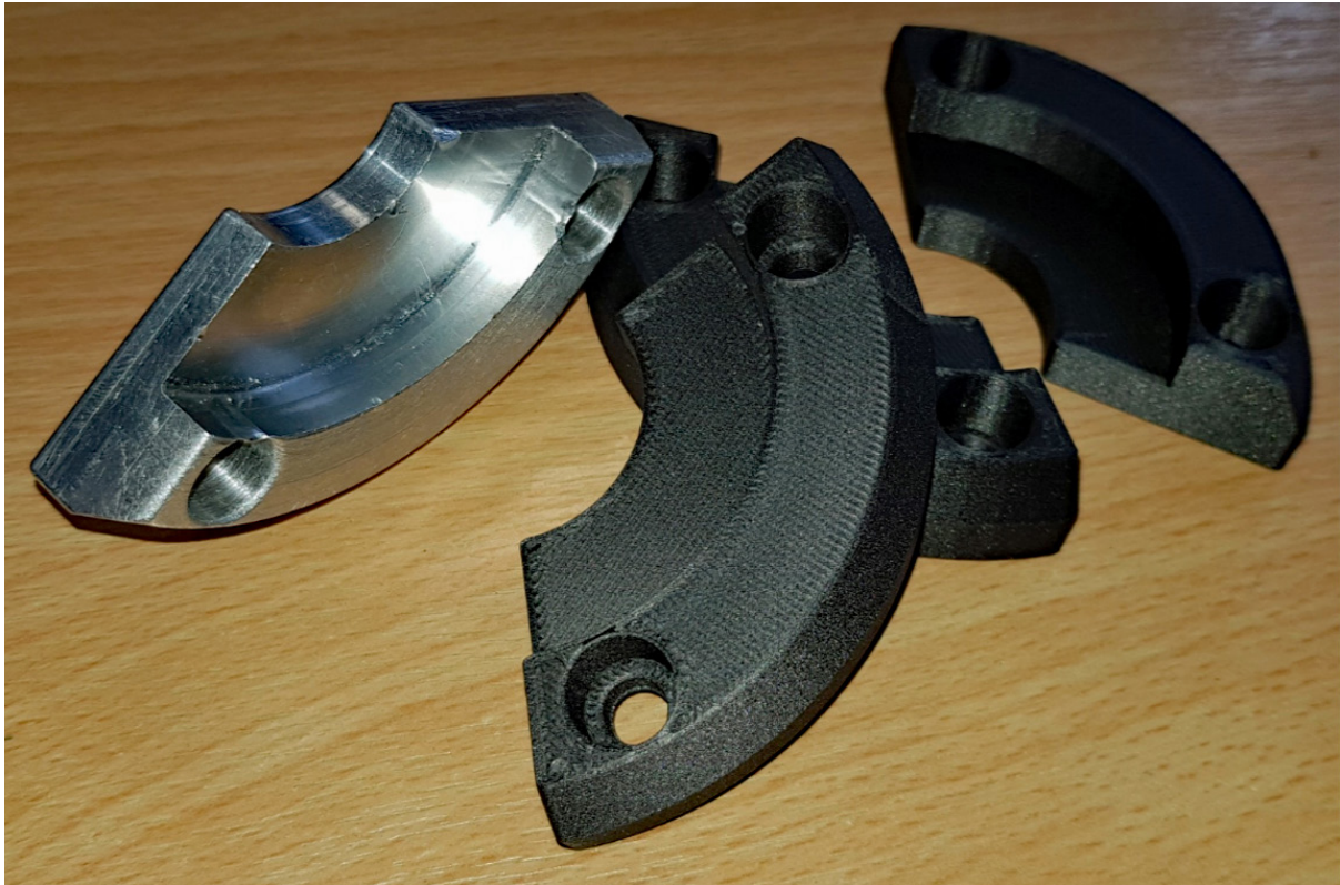
Un accessoire de mâchoire imprimé en 3D fabriqué en FDM nylon 12CF. Ces pièces ont permis de gagner jusqu'à 80 % sur le temps de préparation de la machine.
